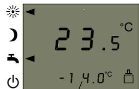
Außentemperatur (bei angeschlossenem Außenfühler)
