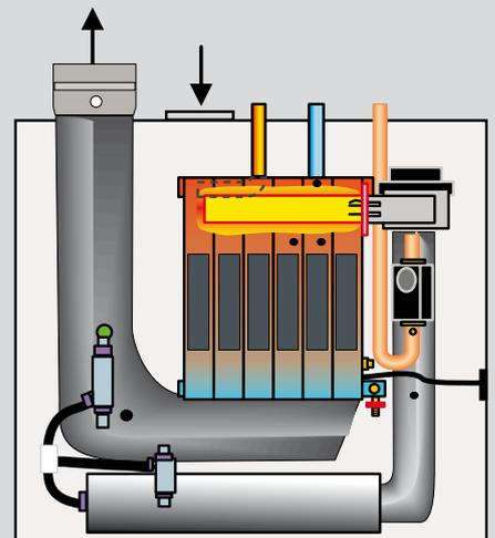
**Gas-Brennwertkessel für Brennwertbetrieb und Warmwasserbereitung**
