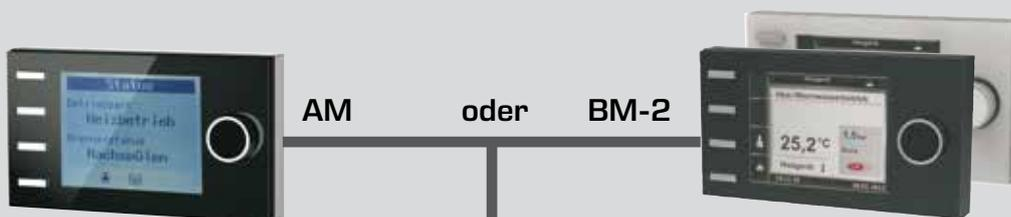
Das AM dient nur als Anzeigemodul für den Wärmeerzeuger. Es können gerätespezifische Parameter und Werte parametriert bzw. angezeigt werden.
